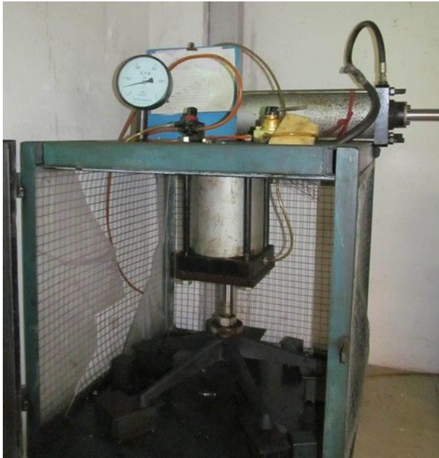
← Base pressing test 脚的压力测试
